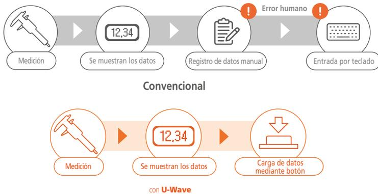
El sistema **U-Wave** es una solución de comunicación de datos inalámbrica diseñada para una transferencia de datos eficiente y precisa desde las herramientas de medición, como calibres y micrómetros, a ordenadores. Agiliza la recopilación de datos, reduce errores y mejora la productividad en los procesos de control de calidad e inspección.
