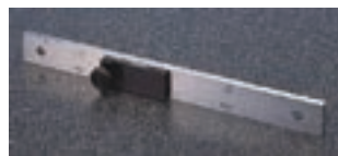
Soporte A : 619031 Utilizado para emparejar dos bloques patrón largos.
