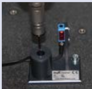
StyliCleaner; palpador siempre limpio y fiable
