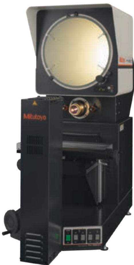
Especificaciones Imagen proyectada Erecto Pantalla Proyectora Diámetro efectivo: 353 mmMaterial de pantalla: vidrio esmerilado finoRotación de la pantalla: \pm 360^\circ , ajuste fino y bloqueoDisplay de ángulo: Contador digital (LED)Resolución: 1' \text{ ó } 0,01^\circ (conmutable)Rango: \pm 370^\circ Modo de conmutación ABS / INC, Puesta a CeroLíneas de referencia: Retículos en cruz. Lentes de proyección 10X (172-184) Opcional : 5X, 20X, 50X, 100X Precisión de aumento Iluminación de Contorno : \pm 0,1\% o mejorIluminación de Superficie : \pm 0,15\% o mejor Iluminación de Contornos Fuente de luz: bombilla halógena (24 V, 150 W)Sistema óptico: sistema telecéntricoFunciones: 2 pasos (Alto / Bajo) de ajuste de brillo, filtro de absorción de calor, ventilador de refrigeración Iluminación de superficie Fuente de luz: bombilla halógena (24 V, 150 W)Sistema óptico: Iluminación vertical Funciones:: Lente del condensador ajustable, 2 pasos (Alto / Bajo) de ajuste de brillo, Filtro de absorción de calor, Ventilador de refrigeración Enfoque Manual Resolución 0,001 mm Fuente de alimentación 220 - 240V AC, 50/60Hz Peso 150 kg
