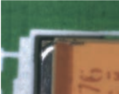
Cuando se usa TAGLENS (TAGLENS ON) TAGLENS cambia el punto de enfoque a gran velocidad. Sin embargo, debido a que el tiempo de captura por fotograma es mayor que el tiempo de enfoque, las imágenes tendrán puntos de enfoque ópticamente mezclados de diferentes alturas, y la imagen aparecerá borrosa.
