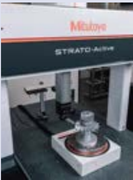
STRATO-Active con la mesa rotatoria MRT320
