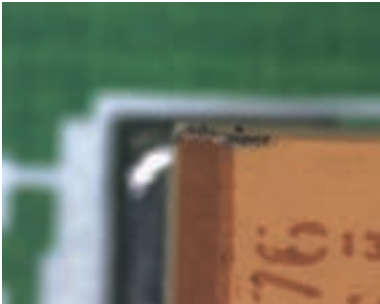
Observación normal al microscopio (superior) Con una diferencia de altura, sólo el plano superior o inferior puede enfocarse.
