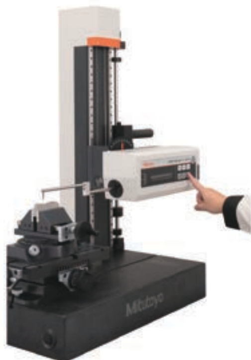
CV-2100M4 con columna y amarre rápido
