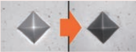
Imagen de observación de la huella (50X) Reducción de la luz dispersa alrededor de la hendidura
