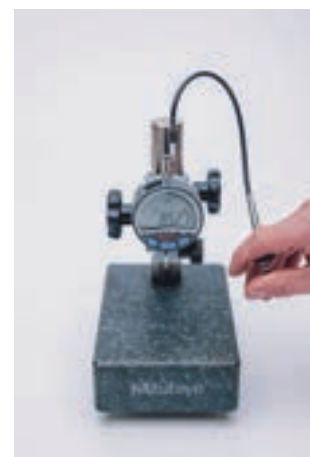
Ejemplo de uso del disparador de cable para elevar el husillo
