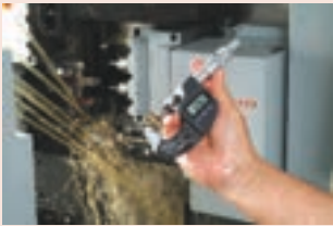
Excelente resistencia contra la entrada de polvo y fluidos (IP65)
