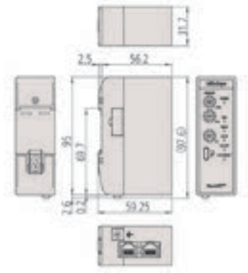
Unidad interface EtherCAT (21HZA264)
